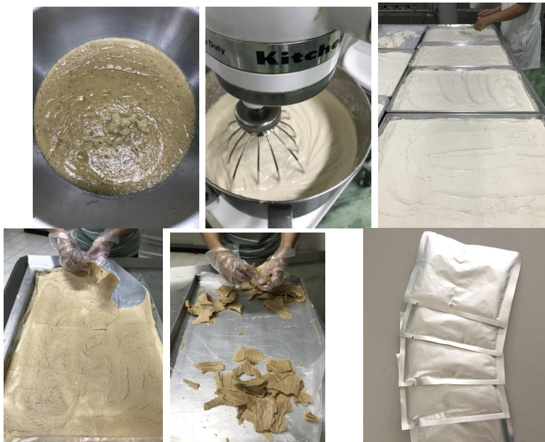
รูปที่ 9.13 ขั้นตอนการผลิตกล้วยหอมผง (ส่วนผสมในผลิตภัณฑ์เครื่องดื่ม ัญญาหารสำเร็จรูป)
