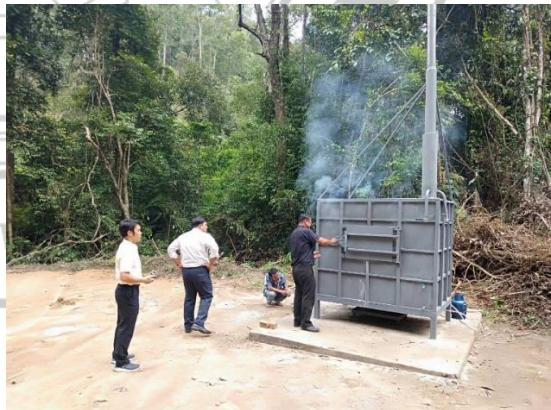
ภาพที่ 4.21 การทดสอบระบบการเผาเชื้อเพลิงของเตาเผาขยะ
