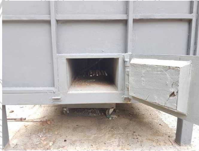
ภาพที่ 4.17 ช่องสำหรับเขี่ยให้ขี้เถ้าจากห้องเผาล่วงลงในถาดรองขี้เถ้า
