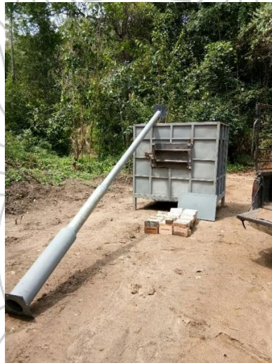
ภาพที่ 4.14 ปล่องควันขนาดสูง 5 เมตร เพื่อให้ควันลอยให้ป่าไม่ดูดซับ
