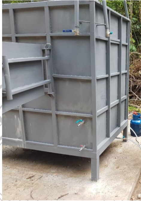
ภาพที่ 4.19 วารัลด้านล่างใช้วัดระดับไอน้ำ วารัลด้านบนต่อจากปล่องควันเพื่อตวงน้ำส้ม ควันไม้ไปใช้ในการเกษตร
