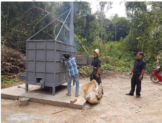
ภาพที่ 4.21 การทดสอบระบบการเผาเชื้อเพลิงของเตาเผาขยะ
