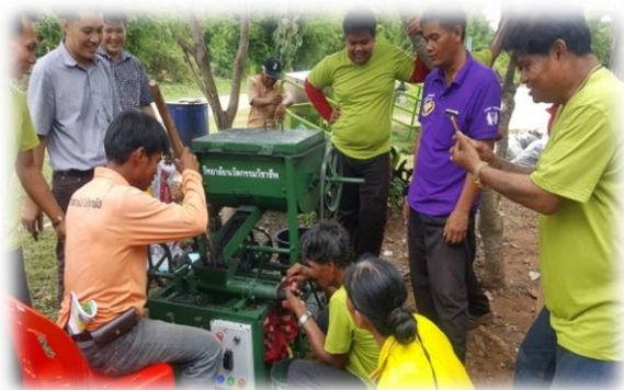
ภาพที่ 4.19 กระบวนการอัดถ่านแท่งจากเหง้ามันสำปะหลังโดยใช้เครื่องอัดถ่าน
