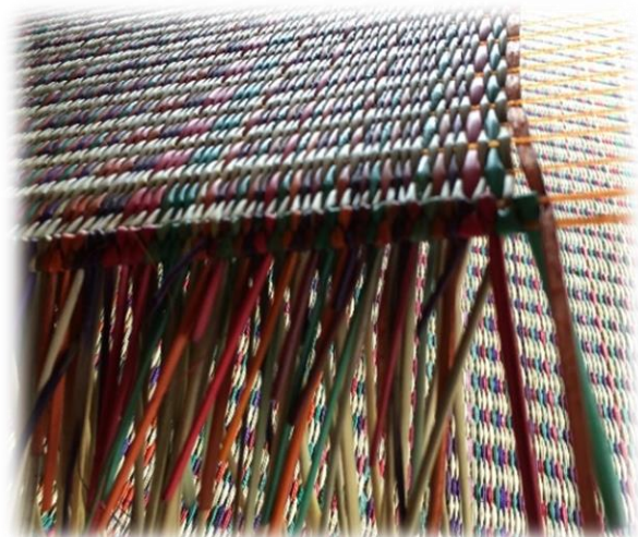
(ค) การทอเส้นใยสีพื้น 5 สี โดยเรียงไล่ตามน้ำหนักสีจากสีอ่อนไปสีเข้ม
