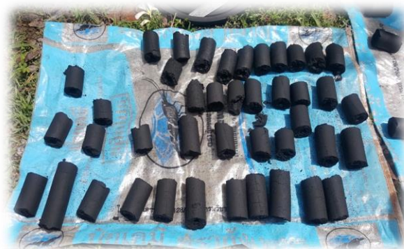
ภาพที่ 4.19 กระบวนการอัดถ่านแท่งจากเหง้ามันสำปะหลังโดยใช้เครื่องอัดถ่าน
