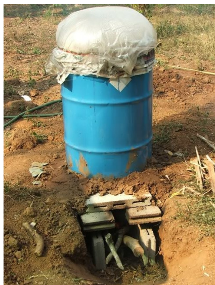
ปิดฝาลังหรือใช้พลาสติกทนความร้อน ปิดปากถังให้แน่น เจาะรู 2-3 รู เพื่อเป็น ทางระบายความดันไอน้ำ จากนั้นสูมไฟ จนน้ำเดือด จับเวลาต่อไปอีก 3-4 ชั่วโมง จึงดับไฟ
