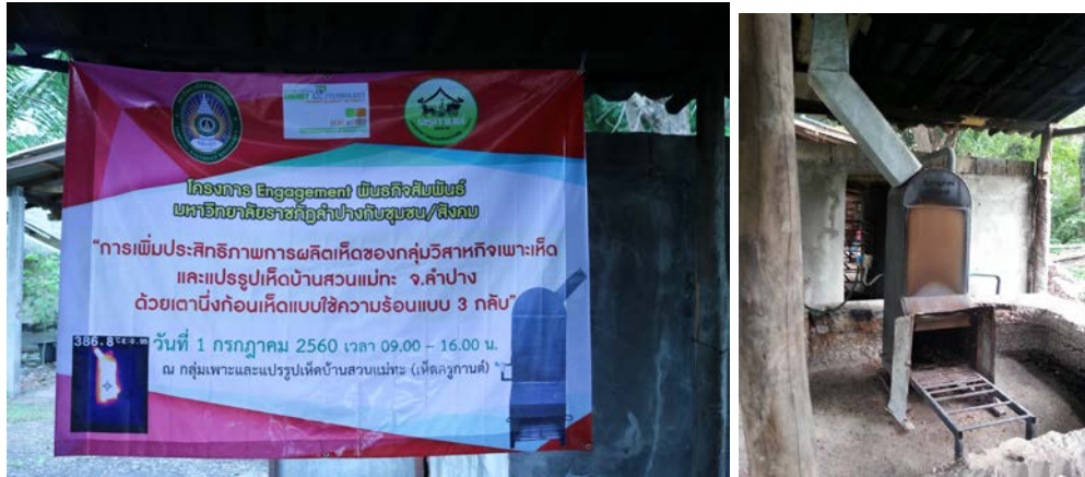
รูปที่ 15 การทดลองใช้เตาเบ็งก้อนหีดแบบใช้ความร้อน 3 กลับ (Trible Pass) ณ คุ่มวิสาหคิจเพาะหีดและแปรรูปหีดบ้านสวนแม่ทะ จ.ลำปาง
