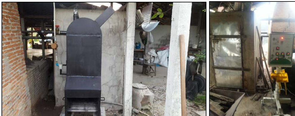
รูปที่ 14 การทดลองใช้เตาหนึ่งก้อนเห็ดแบบใช้ความร้อน 3 กลีบ (Trible Pass) ณ กลุ่มวิสาหกิจชุมชน กลุ่มอาชีพเพาะเห็ดบ้านทุ่งบ่อแป้น ต.ปงยางคค อ.ห้างฉัตร จ.ลำปาง
