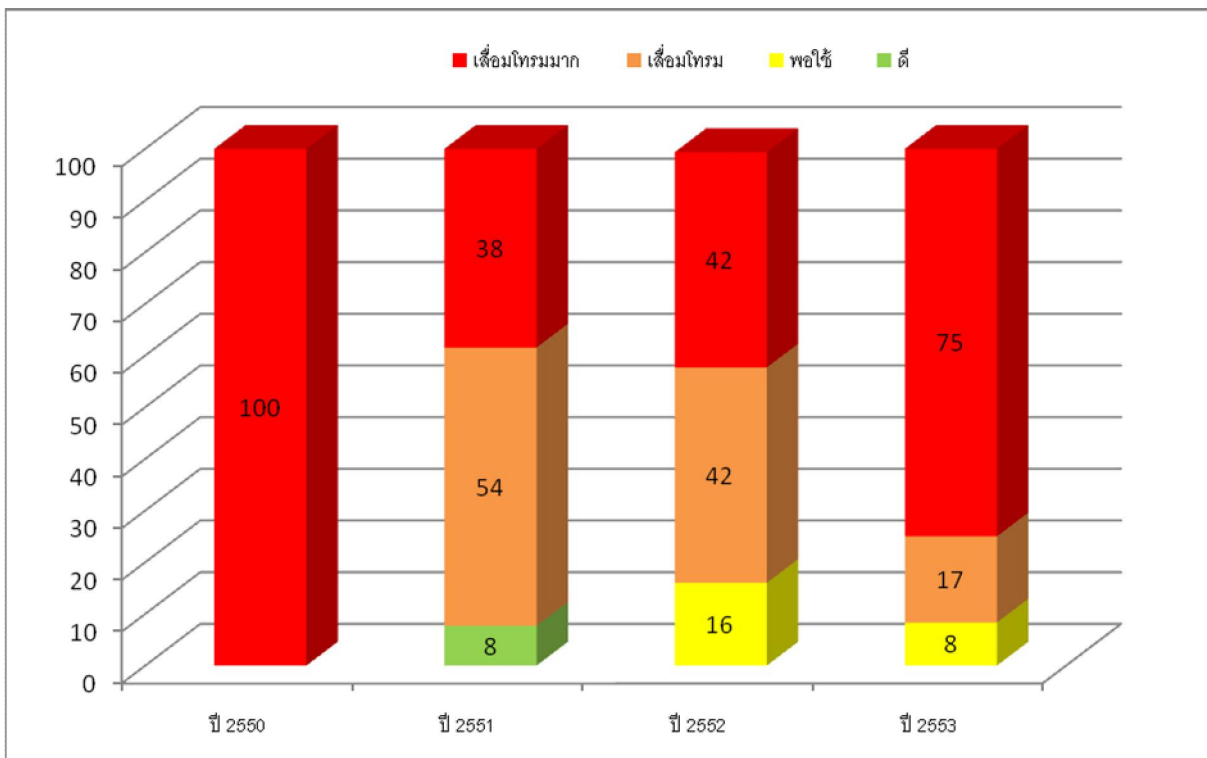
รูปที่ ๖ คุณภาพน้ำ (ค่าความสกปรก: BOD) บริเวณคลองอู่ตะเภา ปี พ.ศ.๒๕๕๐-๒๕๕๓
